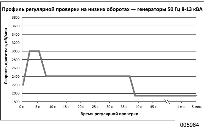
Рис. 3-7. Профиль регулярной проверки на низких оборотах
